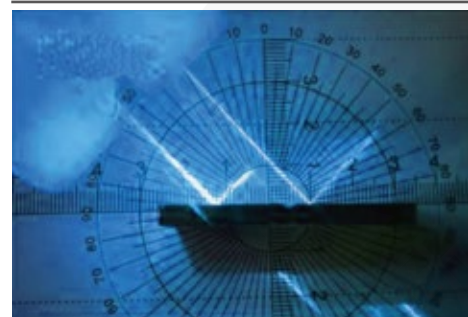
镜面反射 特定角度观察, 反射强度大
